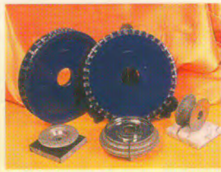
หินเจียรเพชรขอบบัว Diamond wheel for stone craft
